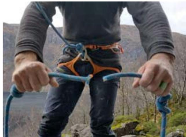
La photo ci-dessus montre une corde qui a été coupée par une chute de pierres sur la falaise de Hetta, à Vaksda. La photo ci-dessous montre la pierre qui s'est détachée lorsque le grimpeur a mis le pied dessus.
