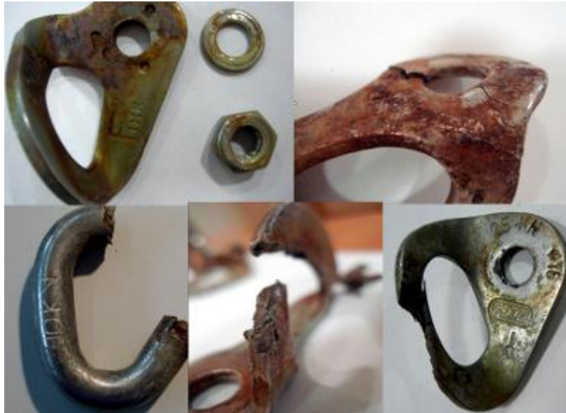
Ancrages attaqués par la corrosion sous tension. Photo: Petzl
