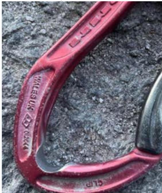
En muchos casos, las fuerzas de corte y las fuerzas de cizalladura actúan simultáneamente. Ambos tipos de fuerza pueden contribuir al corte de la cuerda cuando esta está en contacto con aristas afiladas.
